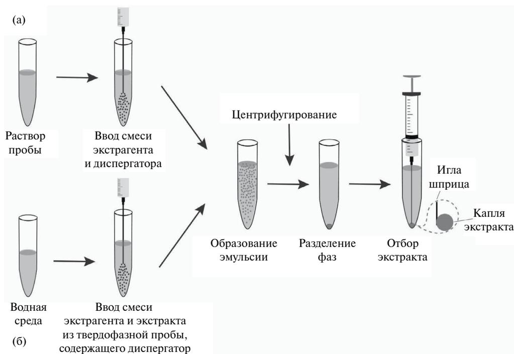
**Рис. 4.** Схема дисперсионной жидкостно-жидкостной микроэкстракции при концентрировании микотоксинов из водного раствора пробы (а) или экстракта из твердофазной пробы (б).
