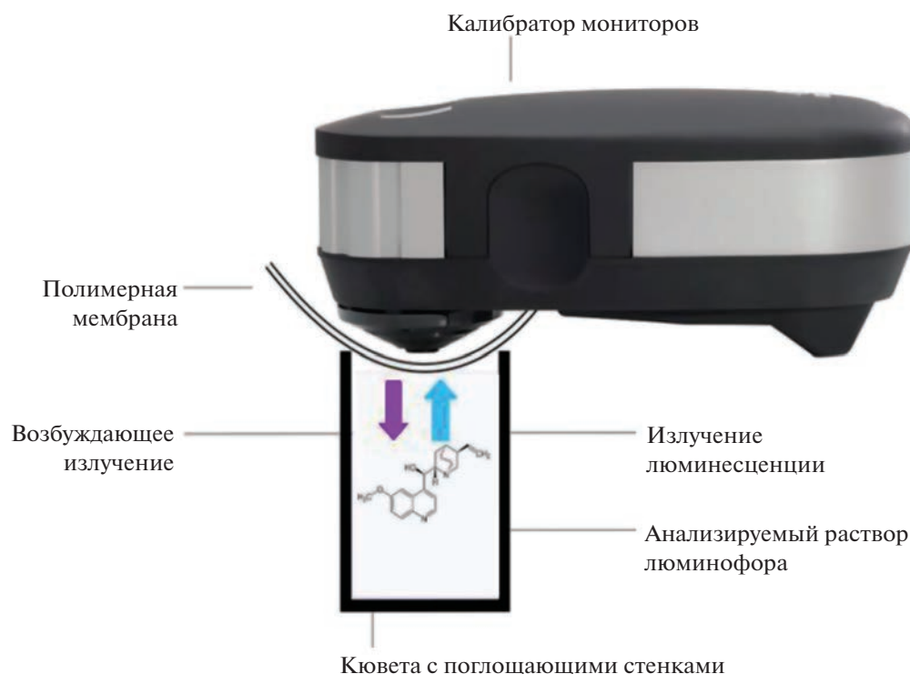
Рис. 1. Схема измерения сигнала люминесценции с помощью калибратора мониторов.
