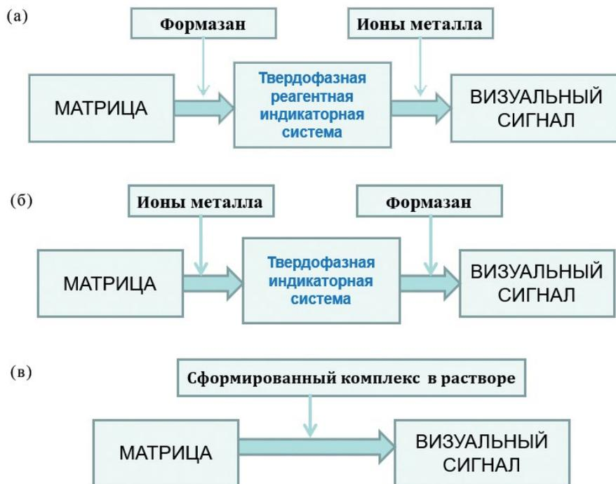
Рис. 1. Методы получения гибридных тест-систем: вариант 1 (а), 2 (б) и 3 (в).
