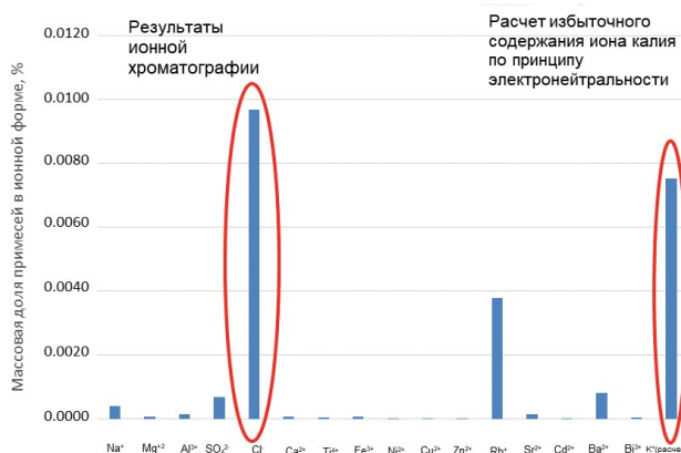
Рис. 2. Значения массовой доли элементов-примесей в предполагаемой ионной форме, присутствующих в анализируемой соли, по результатам измерений методами масс-спектрометрии с индуктивно связанной плазмой и ионной хроматографии.
