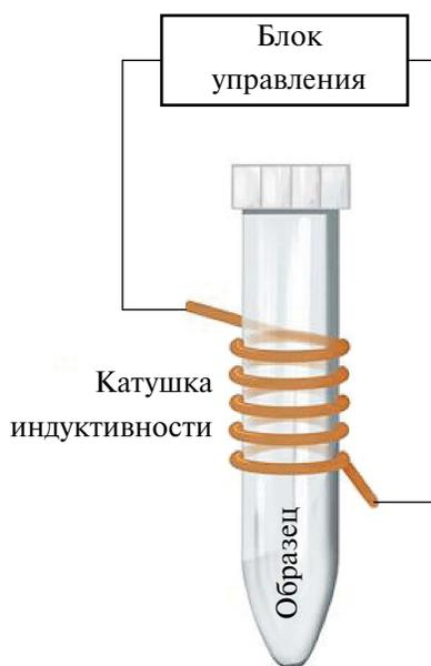
Рис. 2. Общая схема детектора, основанного на методе высокочастотной бесконтактной кондуктометрии.
